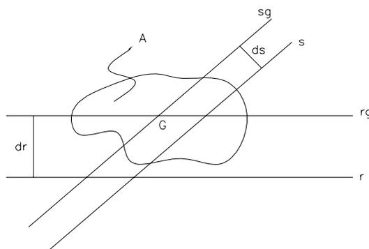
Figura D.9: Teorema dos eixos paralelos.
