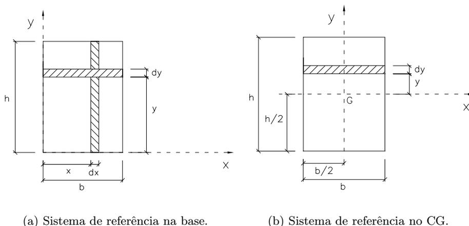
Figura D.2: Elementos de área numa seção retangular.
