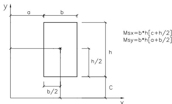
Figura D.4: Cálculo do momento estático a partir da definição do centro de gravidade.
