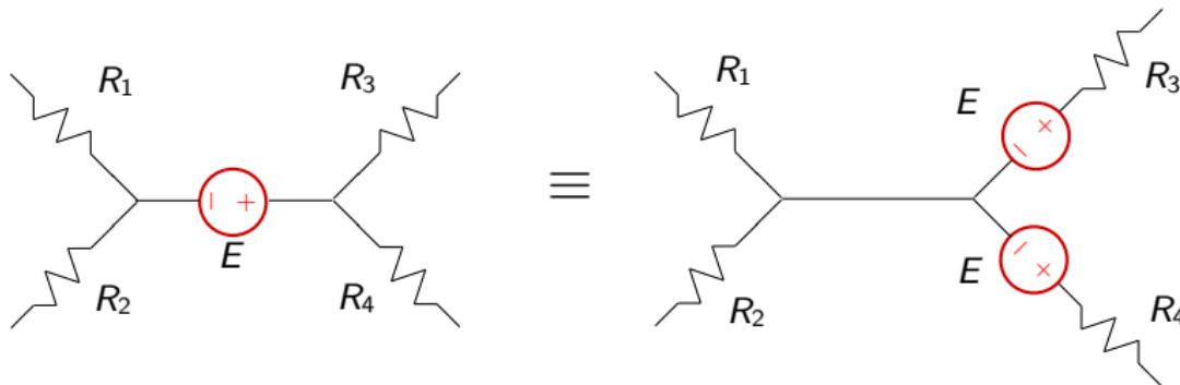
O deslocamento de uma fonte ideal de tensão colocando-a em série com os bipolos das malhas subsequentes (precedentes) e deixando o ramo onde ela estava em curto, não altera as equações do circuito
