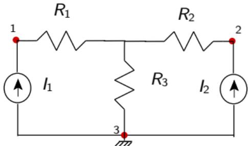
$$\begin{bmatrix} E_{13} \\ E_{23} \end{bmatrix} = \begin{bmatrix} R_1 + R_3 & R_3 \\ R_3 & R_2 + R_3 \end{bmatrix} \begin{bmatrix} I_1 \\ I_2 \end{bmatrix}$$
