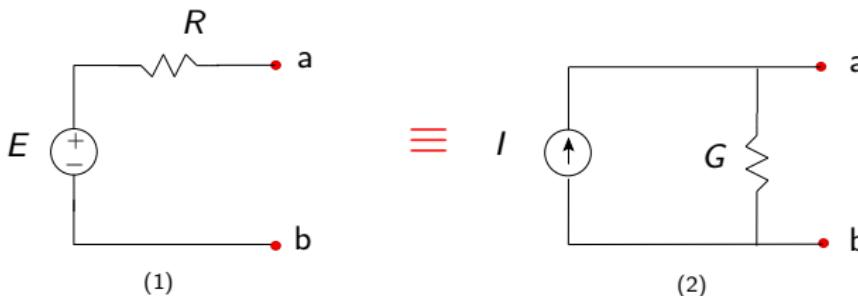
Uma fonte de tensão em série com um resistor pode ser substituída por uma fonte de corrente em paralelo com o mesmo resistor ou vice-versa.
