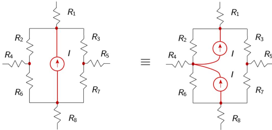
O deslocamento de uma fonte ideal de corrente colocando-a em paralelo com os nós subsequentes (precedentes) e deixando o ramo onde ela estava em aberto, não altera as equações do circuito
