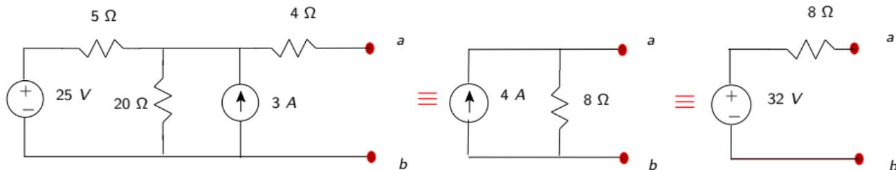
Mostre que a equivalência acima é válida, realizando o procedimento anterior e também, através de transformações sucessivas de fontes.
