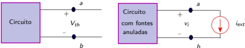
A tensão  $v_i$  é proporcional a  $i_{ext}$ ,  $v_i = -R_{th}i_{ext}$  e, portanto,
