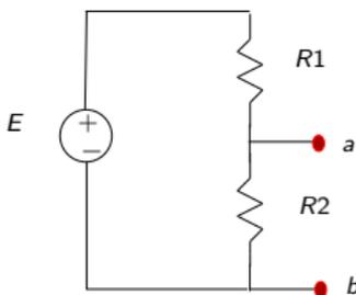
Para calcular  $V_{th}$ , consideramos os terminais  $a$ ,  $b$  em aberto, calculando a tensão sobre eles (com a polaridade positiva em  $a$ ) :
