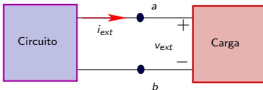
De acordo com o [teorema da substituição](#) podemos substituir a corrente  $i_{ext}$  por uma fonte independente  $i_{ext}$  sem modificação das demais variáveis do circuito.
