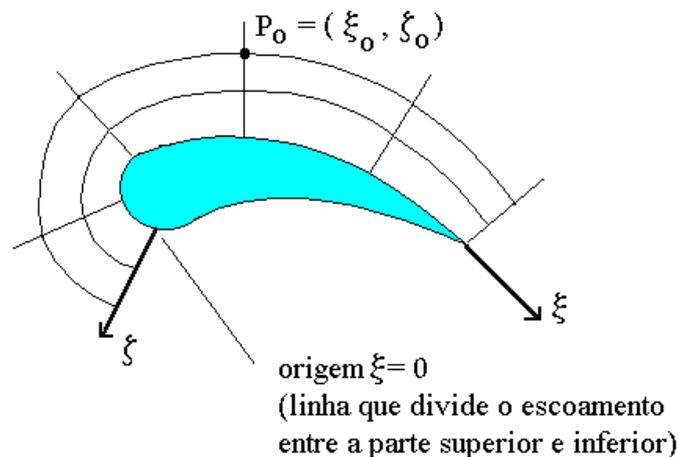
Fig. 2 - Sistema de coordenadas ajustados ao corpo de um aerofólio
