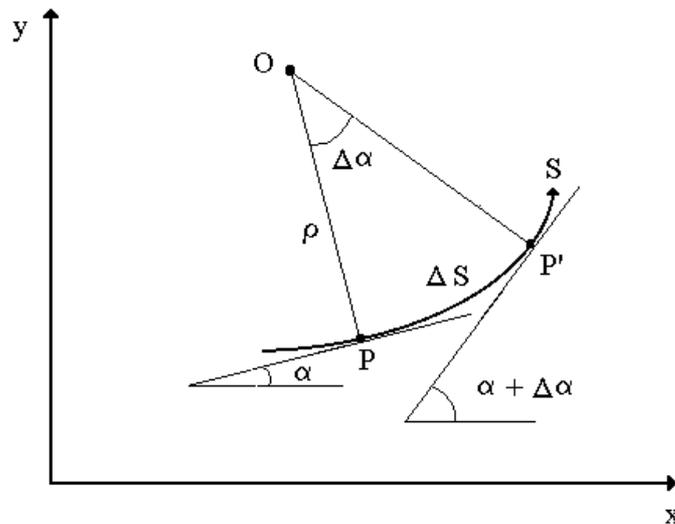
Fig. 3 - Representação de uma curva no plano  $(x,y)$  e de seu raio de curvatura,  $\rho$ .
